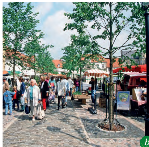
Abbildung 55: Vorläufer moderner Baum-Rigolen am Beispiel der Stadt Osnabrück: a) 40 Linden teilen sich auf einem Platz einen gemeinsamen Wurzelraum, der mit einer sehr grobkörnigen Skeletterde gefüllt ist. b) Solche Anlagen können nach Belieben bedeckt und anschließend belastet werden, ohne dass dem Wurzelraum der Bäume die Gefahr droht, zuvor überverdichtet zu werden.
